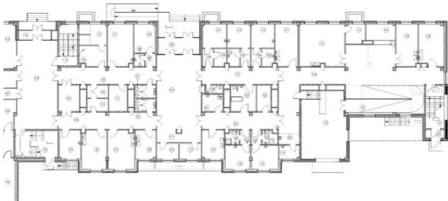
Рис. 8. Типологическая схема типового этажа спального корпуса госпиталя ФТС РФ после реконструкции.
