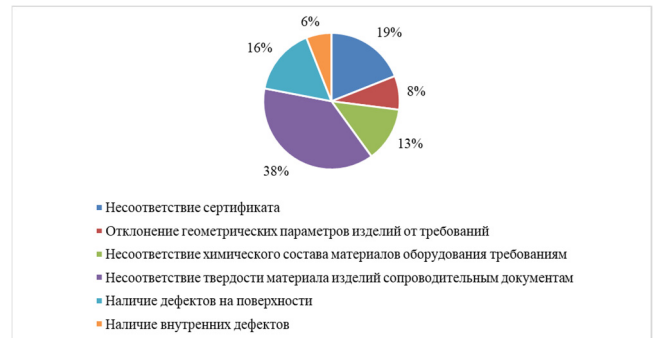
Рисунок 3 – Причины отбраковки арматуры нефтегазового трубопровода (источник: составлено авторами)
