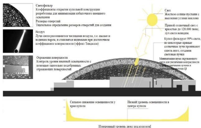
Рисунок 6.: Схема объяснения солнцезащитных зданий Лувра в Абу-Даби архитектор Жан Нувель.
