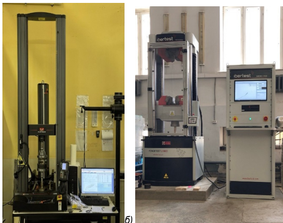
Рисунок 2 - а) универсальная электромеханическая машина Instron-5969 б) сервогидравлическая испытательная машина с компьютерным управлением WERTES U-600
