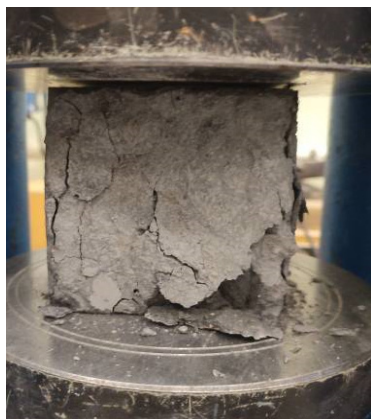
Рис. 3 Проведение испытания образцов кубов на сжатие на гидравлическом прессе
