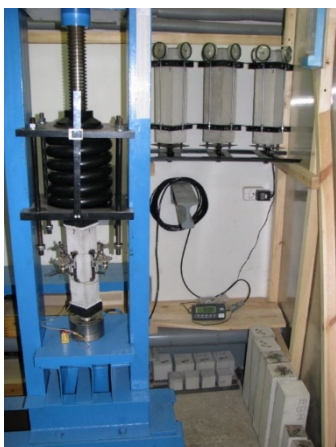
Рис. 2. Длительные испытания. Контроль нагрузки динамометром
