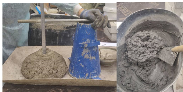
Рис.1 Определение подвижности бетонной смеси
