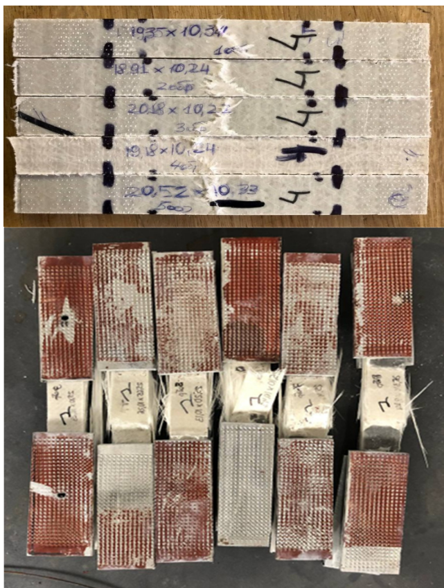
Рисунок 6 - Образцы после испытаний а) поперек волокон, б) вдоль волокон
