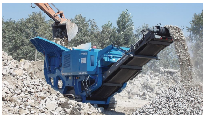
Рисунок 7. Мобильная щековая дробилка железобетонного боя. Источник: https://ex-beton.ru/stati/drobilki-dlya-betona-i-zhelezobetona
