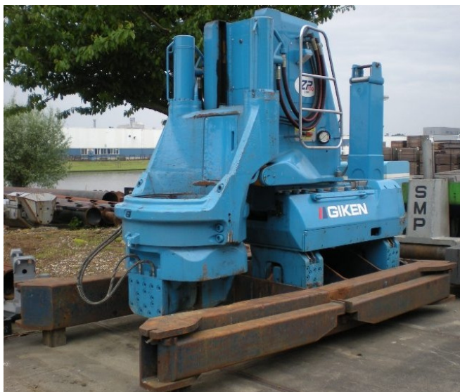
Рис. 1. Установка вдавливания шпунта [URL: https://stispunt.ru/oborudovanie/ustanovki_sticheskogo_zadavlivaniya/giken/ ] (дата обращения: 14.07.2024): 1 – вдавливающий узел; 2 – гидроцилиндры ходовой части, закрепляемые на торцах погруженного шпунтового ряда (3)
